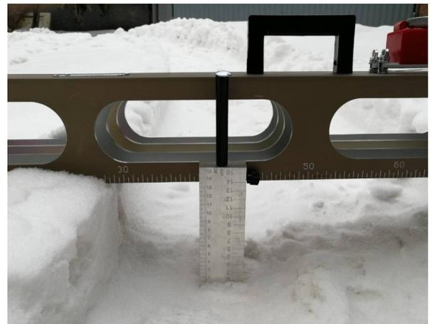
Рисунок 9 – Измерение толщины слоев промерником
